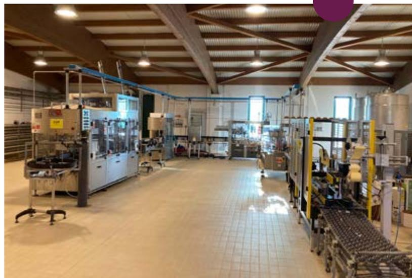
molto importante, che va a chiudere il ciclo produttivo. Durante questa fase vengono prelevate più bottiglie – a inizio, metà e fine processo –, inviate, in un secondo momento, in laboratorio: qui sono effettuate analisi ad hoc, finalizzate alla ricerca di eventuali lieviti, muffe o batteri indesiderati. Attualmente stiamo valutando l'acquisto di un braccio robotico per l'inserimento delle bottiglie all'interno delle scatole nella fase finale del ciclo,
